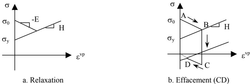
Figure 2.6: Fonctionnement du modèle de Bingham à déformation imposée
